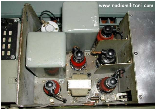
Parte centrale con valvole medie e componenti
