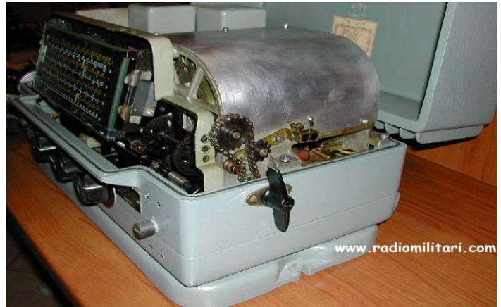
Lato destro con il tamburo cambio gamma e bobine
