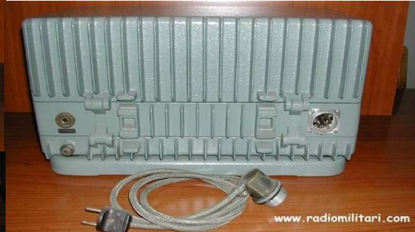
L'apparato posteriormente con presa d'antenna, terra e connettore d'alimentazione
